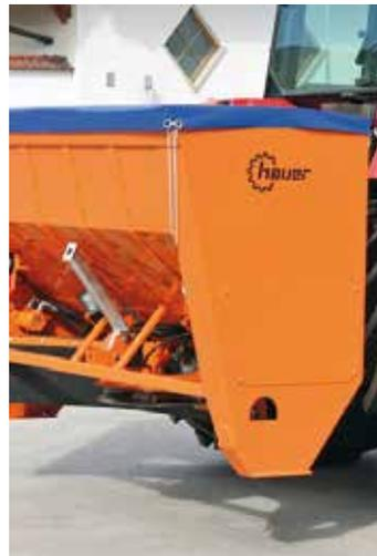
Durch die modernste Ausstattung kann die Streumenge pro m<sup>2</sup> präzise eingestellt werden, was sich wiederum sehr positiv auf den Verbrauch auswirkt. Das Silosystem erleichtert nicht nur die Befüllung, sondern es kann auch die Salzmenge günstiger eingekauft werden. Diese Vorteile ermöglichen eine schnellere Bewältigung der 142 Straßenkilometer.
